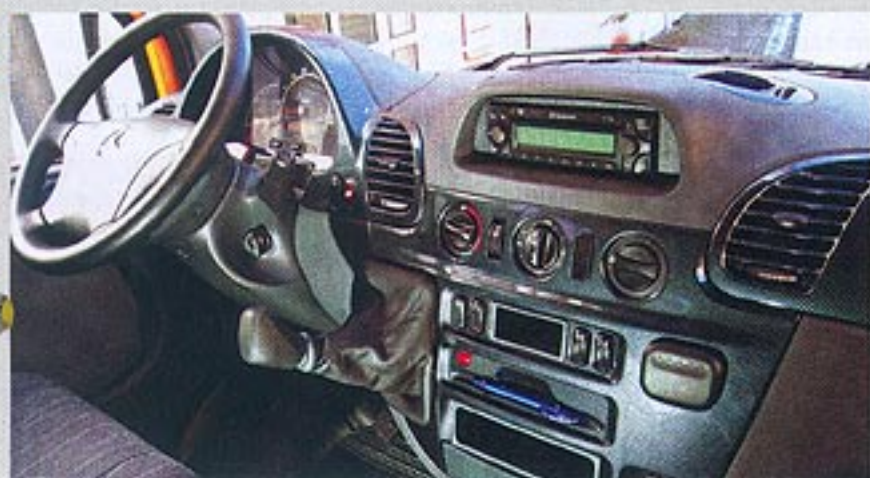
Wie beim G: Aktivierung der Achssperren über Tastschalter in der Mittelkonsole.
