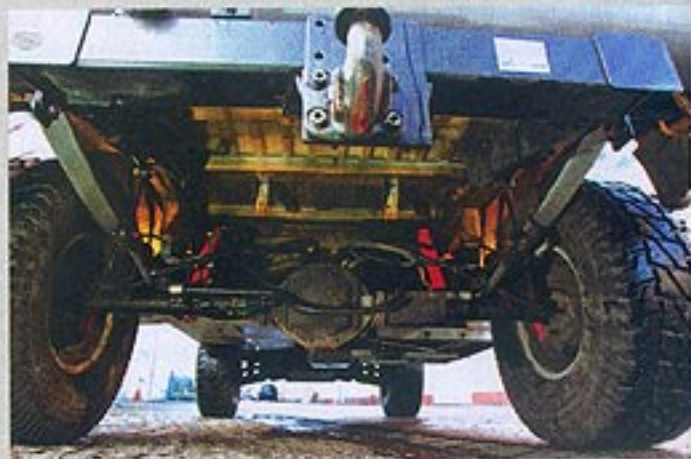
Stabile Bauweise: Hinten trägt der Sprinter eine Starrachse an Blattfedern, die Vorderachse ist ein Iglhaut-Patent.
