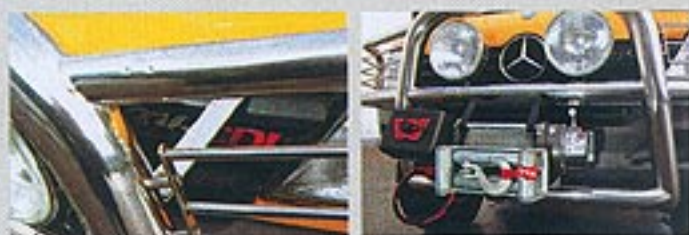
Viel Stahl: Der Frontbügel schützt auch die Scheinwerfer, ein Steck-Adapter nimmt die Seilwinde auf.
