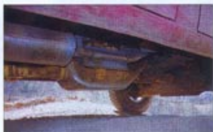
Das gelb lackierte Verteilergetriebe wurde nachträglich an's Hauptgetriebe gekoppelt
